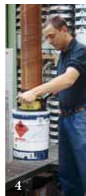
4. Een VacuEasylift voor het tillen van vaten, emmers en blikken is een populair hefsysteem in de farmaceutische en chemische industrie. We leveren zuigvoeten voor het heffen van 1 of meer blikken tegelijk.
