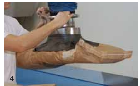
4. Alle modellen van de VacuEasylift zijn in RVS leverbaar. Geschikt voor toepassingen in o.a. de stofvrije ruimtes en corrosieomgevingen.
