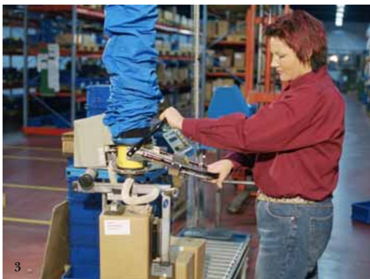
1–2. Een hoekadapter met hendel lost het probleem van vertikaal naar horizontaal vertikaal heffen.
