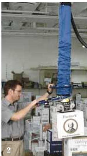
2. Verkopers van alcoholische dranken gebruiken de VacuEasylift voor het tillen van dozen, kratten en fusten. Deze units zijn met een speciale hendel uitgerust.
