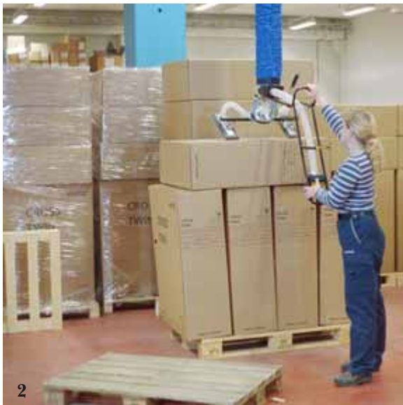
1–2. Een hoekadapter met hendel lost het probleem van vertikaal naar horizontaal vertikaal heffen.
