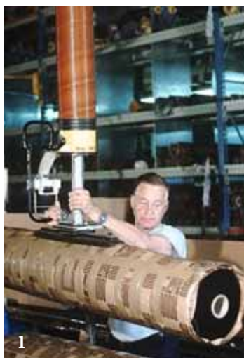
1. Een voorbeeld van installatie waarbij de zuigvoet op een oneffen oppervlakgeplaatst moet worden. Voordat de VacuEasylift was geïnstalleerd was dit vaak een klus waar 2 personen voor nodig waren.
