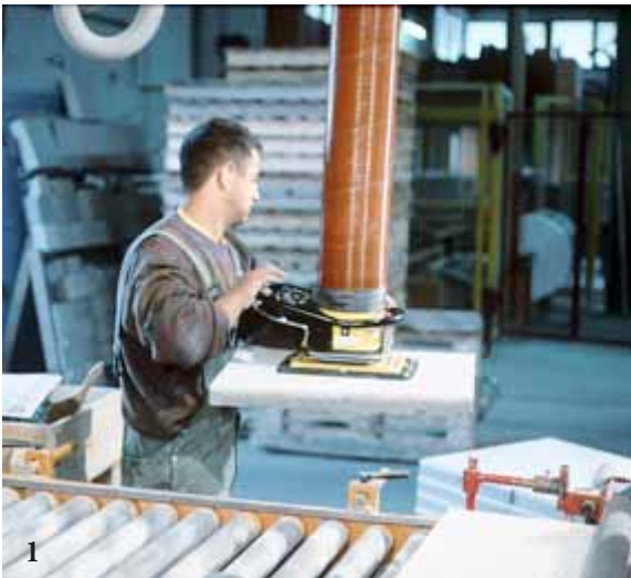
1. De VacuEasylift voorkomt overbelasting van schouders en rug, zoals hier in de bouwindustrie.
