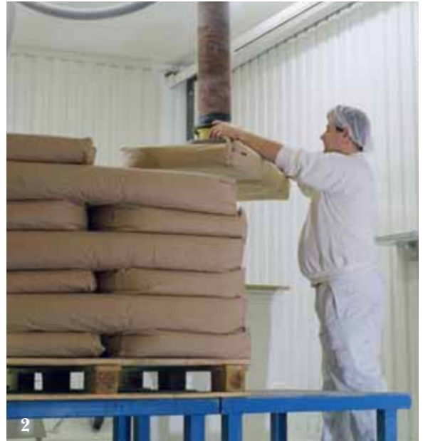
1-2. Het handmatig tillen van zakken is extreem zwaar en staat daarom in de VacuEasylift top 10 van de meest populaire toepassingen. De VM 160 kan zakken tot 60 kg tillen, genoeg om bijna alle zakken die gebruikt worden in de voedingsmiddelen- en chemische industrie te heffen.
